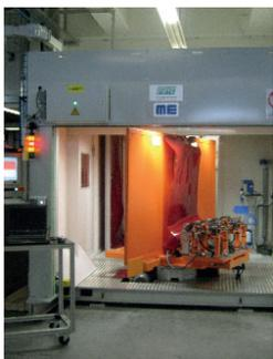
Diese Kabine zeichnet sich durch hohe Stabilität aus. Sie wurde so konstruiert, dass sie bei Montage auf einem Grundrahmen ohne Demontage mittels Kran verladen, entladen und beim Empfänger wieder aufgestellt werden kann (Siehe Foto 1 + 2).
